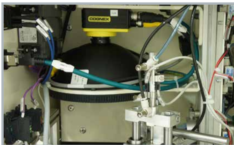
Bildverarbeitungssystem mit Kamera in einer unserer Maschinen mit großer Dombeleuchtung für die Vermeidung von Glanzstellen
