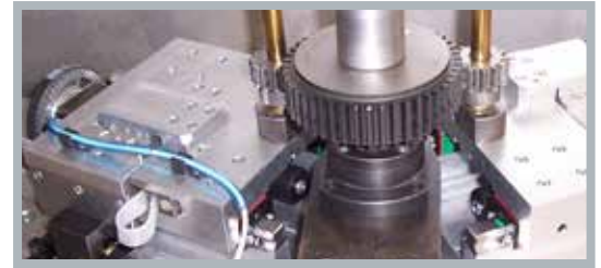
Submikrometer-Messwerk einer Zahnradprüfvorrichtung
