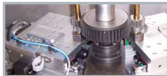
Fogaskerék-vizsgáló berendezés szubmikrométeres mérőműve
